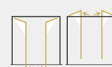
2 vantaux : ouvertures intérieures et extérieures
