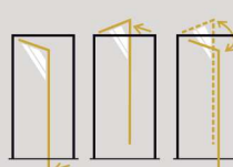
1 vantail : ouverture intérieure, extérieure et va-et-vient
