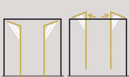
2 vantaux : ouvertures intérieures et extérieures
